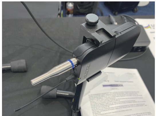
ワイヤレス送信機に実装したTX-3
