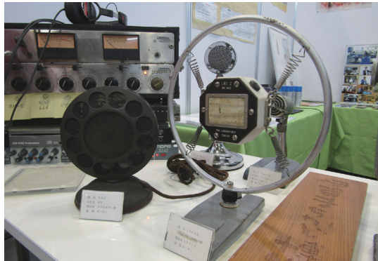
米国WEのダブルボタン型カーボンマイク(左)と 日本製カーボンマイクLEITZ
